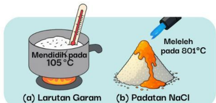
Gambar 7. (a) Larutan NaCl memiliki titik didih >100\text{ }^{\circ}\text{C} (b) Padatan NaCl meleleh 801\text{ }^{\circ}\text{C}
