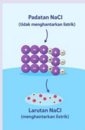
Gambar 2. Senyawa ionic NaCl sebagai larutan elektrolit kuat
