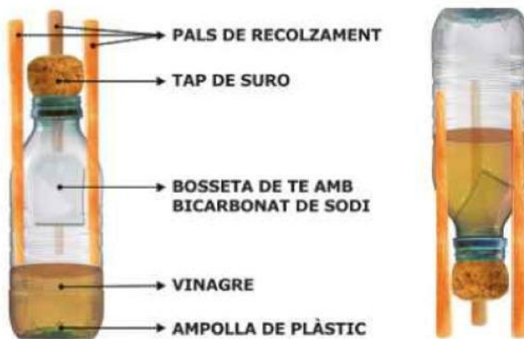
Figura 4. Muntatge experimental coet casolà
