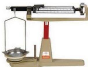
Neraca Sama Lengan adalah jenis alat ukur massa yang bekerja berdasarkan prinsip keseimbangan atau kesetimbangan. Alat seperti pada gambar di atas ini memiliki dua lengan yang sama panjang dan di setiap ujung lengannya terdapat piringan atau wadah untuk meletakkan benda. Neraca ini seringkali diasosiasikan dengan timbangan emas atau perhiasan, karena kemampuannya menimbang massa yang sangat kecil dengan ketelitian tinggi.
