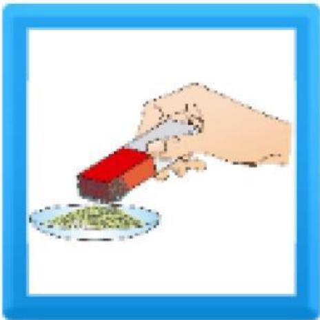
**El método de separación de mezclas que muestra el dibujo es la imantación**
