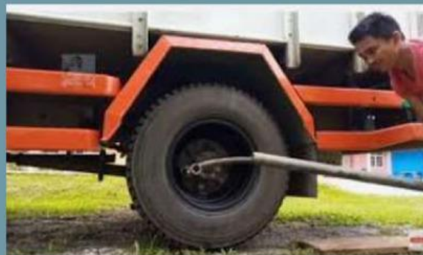
Gambar 2. Melepas baut dengan tuas
