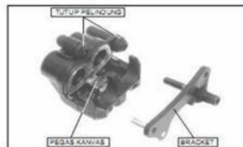
Gambar 5. 8 Pembongkaran Kaliper Rem
