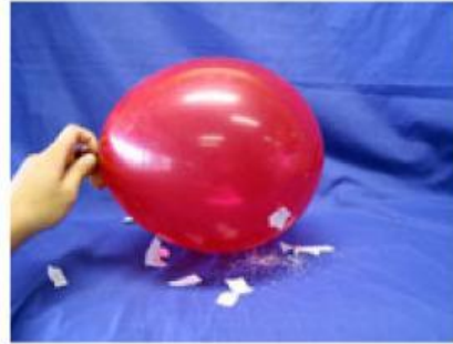
Gambar 1.2. Balon yang didekatkan ke kertas setelah digosokkan ke kain wol sumber : physicmax
