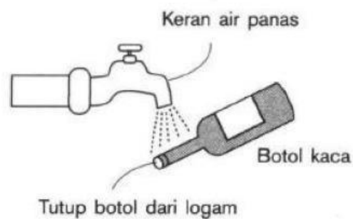
Gambar 4: Tutup botol kaca yang sulit dibuka lalu mudah dibuka setelah dipanaskan leher botolnya
