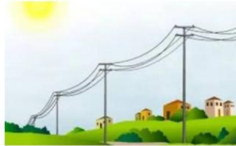
Gambar 2. Kabel listrik yang terlihat kendur di siang hari
