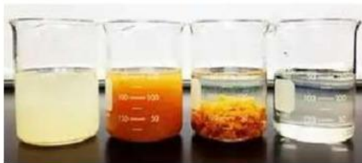
Proses penjernihan air kotor menggunakan tawas
