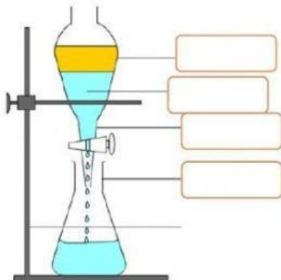
El montaje experimental corresponde a la técnica de \_\_\_\_\_. Esta técnica se emplea para sustancias que no son \_\_\_\_\_ y tienen distinta \_\_\_\_\_, por ejemplo \_\_\_\_\_ y \_\_\_\_\_. El agua, más densa, queda en la parte inferior, pudiéndose separar así del \_\_\_\_\_.
