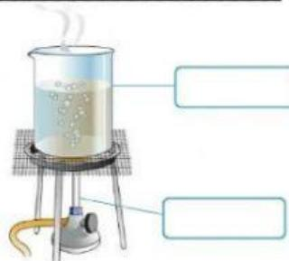
El montaje experimental corresponde a la técnica de \_\_\_\_\_. Esta técnica se emplea para separar sólidos solubles en líquidos. Por ejemplo, sal y \_\_\_\_\_. Se calienta hasta evaporar el agua, quedando la sal en estado \_\_\_\_\_.
