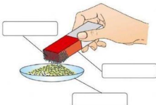
La separación \_\_\_\_\_ se utiliza para separar sustancias que presentan propiedades \_\_\_\_\_ de aquellas que no. Por ejemplo, trocitos de \_\_\_\_\_ de otra sustancia como puede ser arena o azufre.
