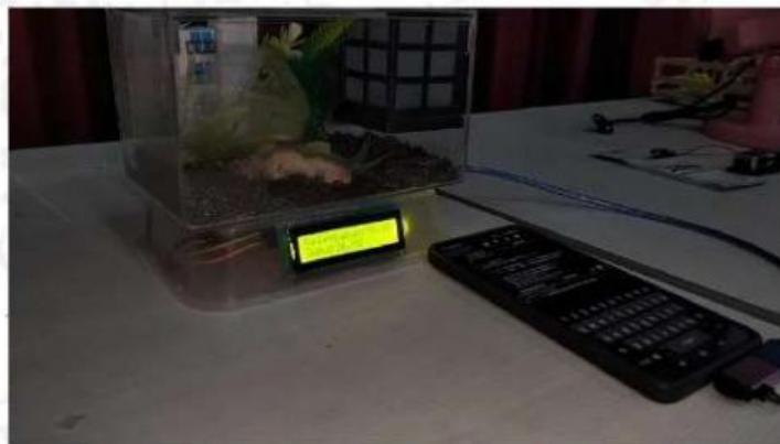
Alat peraga efek rumah kaca berbasis sensor suhu dan kelembaban (di buat oleh kelompok 3 perubahan iklim mk.Media pembelajaran)
