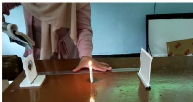
Gambar 2: Set Percobaan Cermin Cekung Sumber: Youtube
