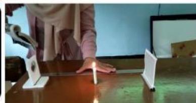
Gambar 2: Set Percobaan Cermin Cekung Sumber: Youtube
