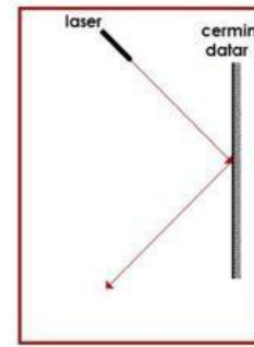
Gambar 3 Rangkaian percobaan pemantulan cahaya
