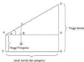
3. Ukurlah tinggi objek menggunakan klinometer sederhana, dengan langkah-langkah berikut:
