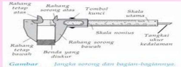
Gambar jangka sorong dan bagian-bagiannya.
