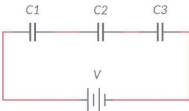
Las preguntas 1 a 3 están relacionadas con este circuito capacitivo. Donde  $C_1 = 210 \mu\text{F}$ ,  $C_2 = 420 \mu\text{F}$ ,  $C_3 = 630 \mu\text{F}$  y la alimentación = 12,0V.
