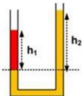
2. Pipa U diisi dengan air dan cairan minyak seperti terlihat pada gambar! Jika ketinggian air  $h_2$  adalah 25 cm, massa jenis minyak  $0,8 \text{ gr/cm}^3$  dan massa jenis air adalah  $1\text{gr/cm}^3$  tentukan tinggi minyak ( $h_1$ ) ..... ( cm )
