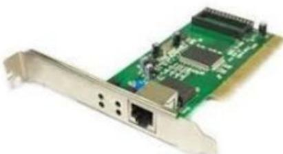
Gambar disamping berfungsi sebagai jembatan dari computer ke jaringan computer. Kartu ini dapat mengubah, mengirim dan menerima data ke jaringan merupakan pengertian dari perangkat tambahan berupa
