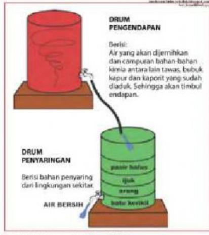
Gambar . Drum penyaring dan drum pengendapan
