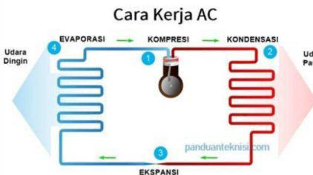
Gambar 3. Prinsip Kerja AC (sumber : Edutech.com)
