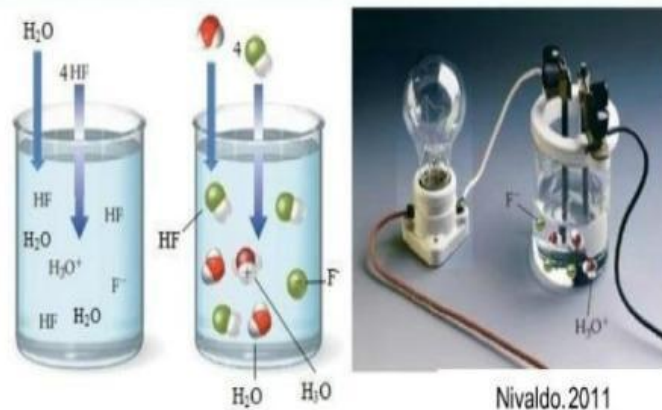
Gambar 22. Ionisasi larutan HF dan daya hantar listrik larutan HF (Sumber: Nivaldo, 2011)
