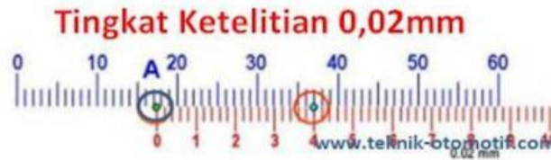
Gambar 12. Skala metris tingkat ketelitian 0,02 mm
