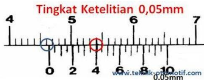
Gambar 11. Skala metris tingkat ketelitian 0,05 mm
