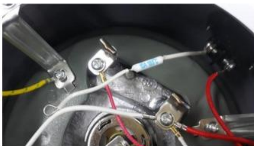
รูปที่ 5.4 แสดงตำแหน่งของเทอร์โมฟิวส์
