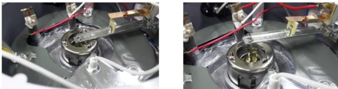
รูปที่ 5.7 แสดงตำแหน่งสวิตช์แม่เหล็ก (เทอร์โมสแตส)
