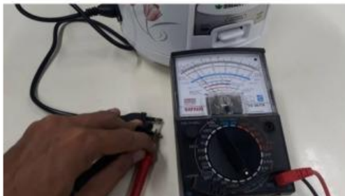
รูปที่ 5.1 แสดงการตรวจสอบเต้าเสียบหม้อหุงข้าวไฟฟ้า
