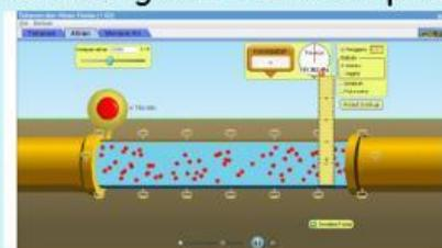
8. Letakkan alat pengukur kecepatan aliran di tengah-tengah selang tersebut seperti pada gambar dibawah ini! Kemudian catatlah nilai yang muncul pada data pengamatan!
