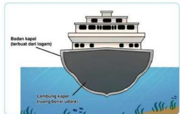
Gambar 1.2 Struktur kapal laut
