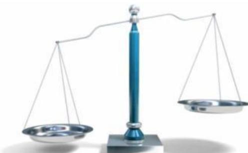
Timbangan dua lengan adalah alat yang digunakan untuk mengukur massa atau berat suatu benda. Dua lengan pada timbangan akan berada di posisi yang sama (tidak ada yang lebih tinggi atau lebih rendah) atau seimbang saat beban di kedua lengan sama yang menunjukkan massa di lengan kanan dan lengan kiri sama. Namun, ketika satu sisi ditambah beban dengan berat tertentu, maka akan merusak keseimbangan sehingga sistem menjadi tidak seimbang.
