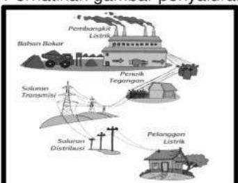
Berdasarkan gambar disamping, komponen utama dalam proses penyaluran energi listrik adalah transformator penaik dan penurun tegangan, saluran transmisi dan saluran distribusi. Energi listrik disalurkan ke rumah-rumah warga melalui ....
