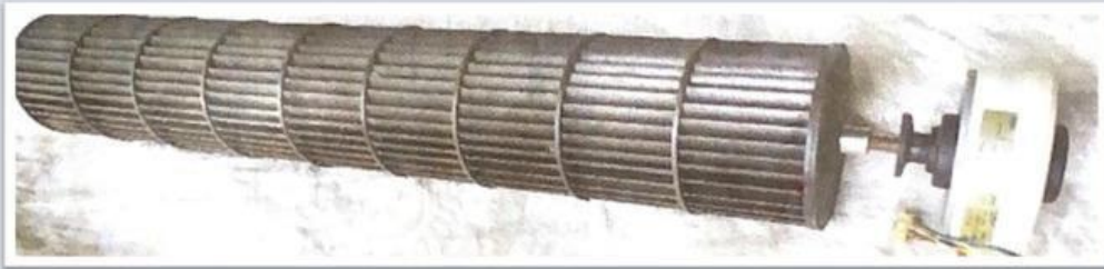
พัดลมแบบครอสโฟลว์
