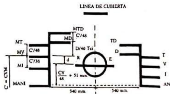
Fig. 436 Líneas de máxima carga para transportar cubertada de madera.
