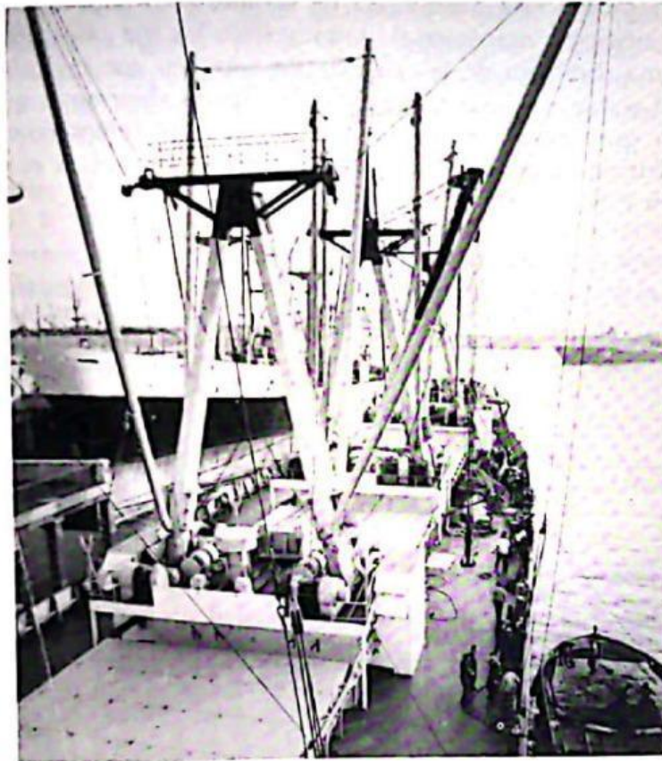
Fig. 219 Puntales en un buque de carga general
