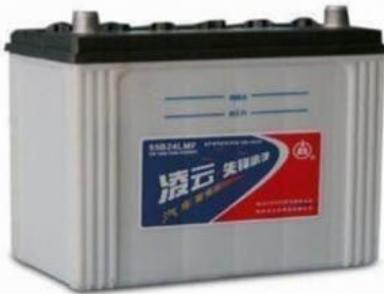
The Lead Storage Battery dikenal dengan sebutan baterai mobil atau aki/accu. Baterai penyimpan plumbum (timbal) terdiri dari enam sel yang terhubung secara seri. Anoda pada setiap sel adalah plumbum (Pb), sedangkan katodanya adalah plumbum dioksida (PbO<sub>2</sub>). Elektroda dicelupkan ke dalam larutan asam sulfat (H<sub>2</sub>SO<sub>4</sub>).
