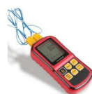
Gambar 2.5 Termometer termokopel Sumber: https://sumberbelajar.seamol.ac.org/Media
