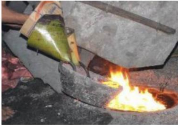
Gambar 1.4 Penuangan ke cetakan Sumber: (Ariawarman, 2017)
