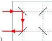
3. Los rayos láser se reflejan en los espejos de la forma que se muestra en la imagen
