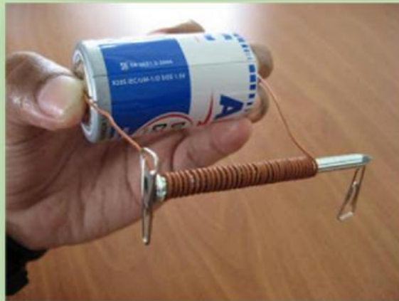
Gambar 2. Cara membuat magnet dengan dialiri arus listrik searah (DC)
