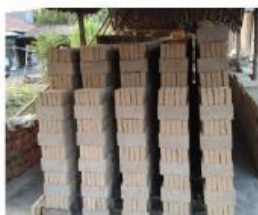
Gambar 5. Proses Pengeringan Bata
