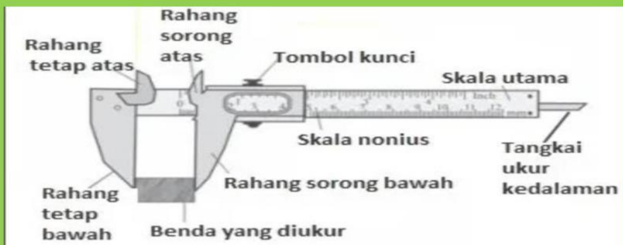
Gambar 2. Bagian-bagian Jangka Sorong
