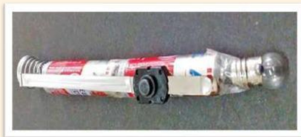
Gambar 1.2 senter dibongkar Sumber: Dok. Kamendikbud
