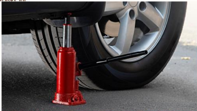
Gambar 1. Mobil terangkat dengan bantuan dongkrak hidrolik
