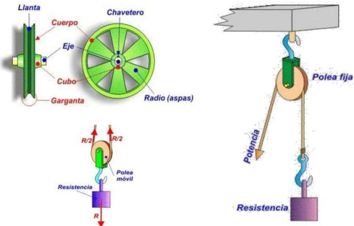
Tanto la polea como la rueda y el eje pueden considerarse máquinas simples que constituyen casos especiales de la palanca. Una polea fija no proporciona ninguna ventaja mecánica, es decir, ninguna ganancia en la transmisión de la fuerza: sólo cambia la dirección o el sentido de la fuerza aplicada a través de la cuerda. Sin embargo, con un sistema de poleas móviles (también llamado polipasto) sí es posible obtener una ventaja o ganancia mecánica.
