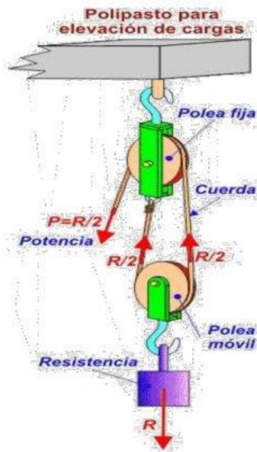
Para disminuir aún más el esfuerzo frente a la resistencia, se utilizan combinaciones de poleas, cada par de poleas (una fija y otra móvil) posibilita dividir por dos el esfuerzo necesario para equilibrar o vencer la resistencia.
