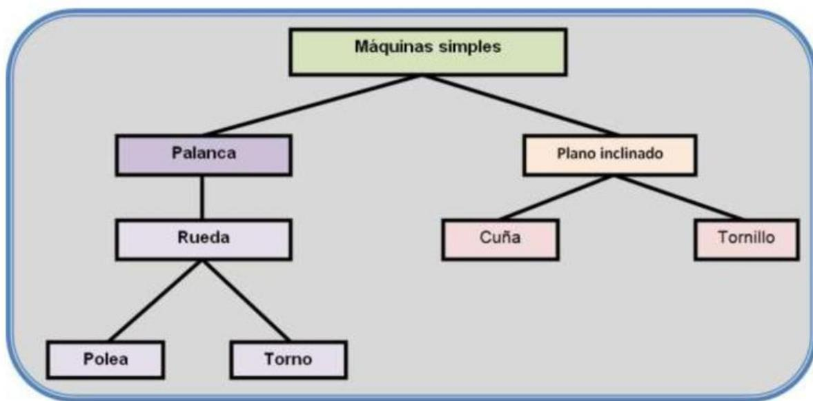
Las maquinas simples permiten disminuir el esfuerzo para realizar un trabajo, pero toda disminución de la fuerza va acompañada por un aumento de la distancia que recorre el punto de aplicación de la fuerza.
