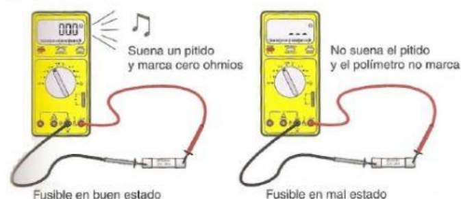
Figura 5.8. Comprobación de un fusible con polímetro.
