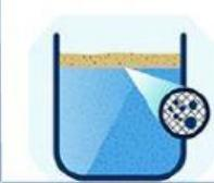
Nº1) Elimina los sólidos de gran tamaño, aplica una predesinfección y separa la arena del agua para no dañar las bombas de la ETAP.
