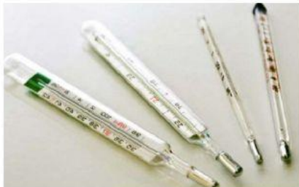
Gambar 4.3 Termometer zat cair
