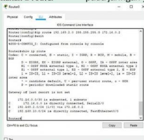
Gambar 56. tampilan tabel routing Router0 pada jaringan yang menggunakan 3 router
