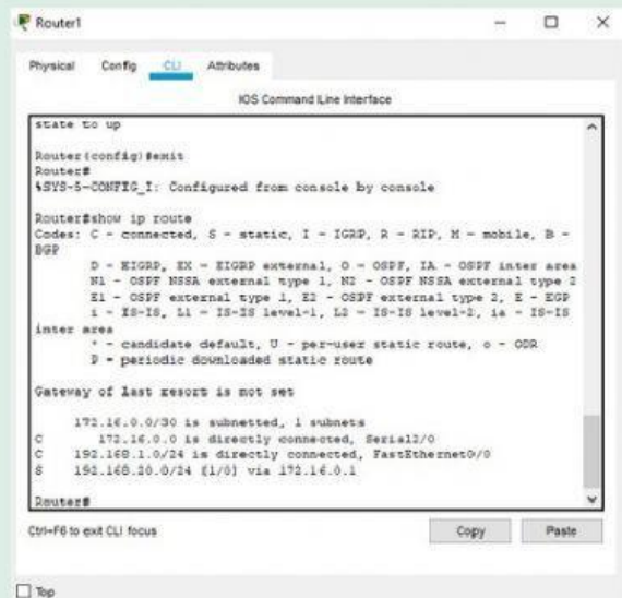
Gambar 55. tampilan tabel routing Router1 pada jaringan yang menggunakan 2 router
