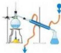
3.Separa dos líquidos por su diferencia en la temperatura de ebullición.
