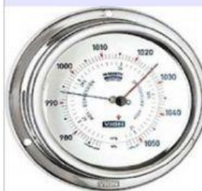
Barómetro: mide la presión atmosférica.
