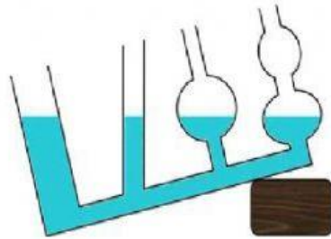
Gambar 2. Bejana berhubungan posisi miring
