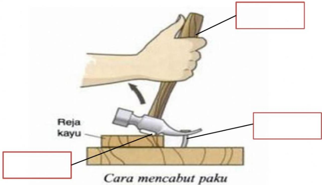
Semakin dekat jarak beban dari \_\_\_\_\_, semakin \_\_\_\_\_ daya diperlukan untuk mengangkat beban.
