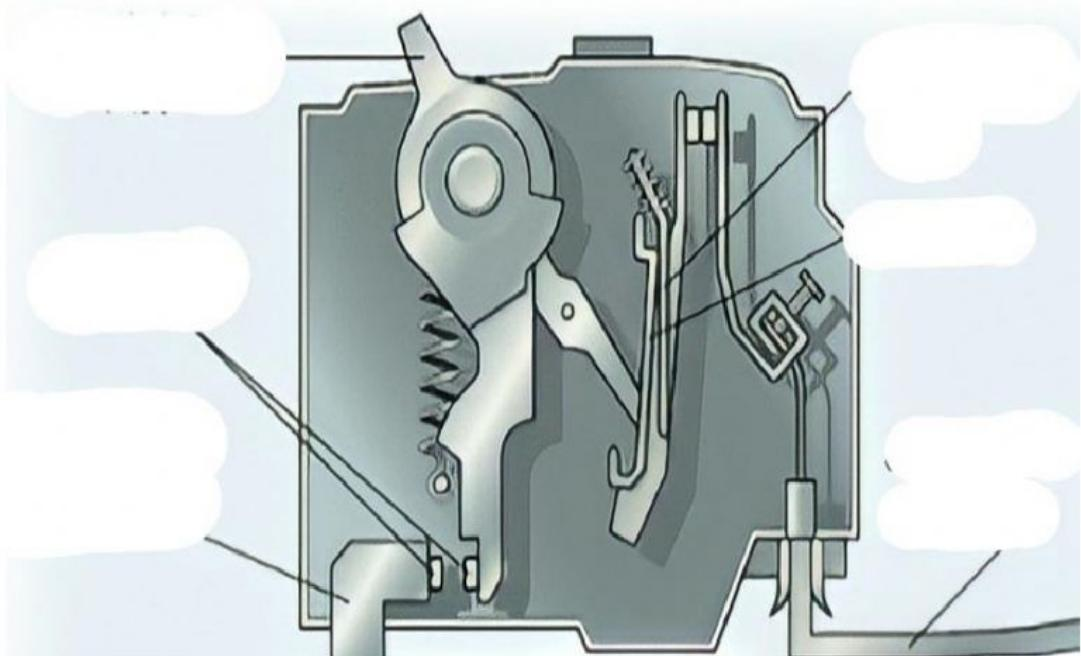
المزلاج التيار الخارج نحو الاحمال ذراع المفتاح التيار القادم من المفتاح المركزي
